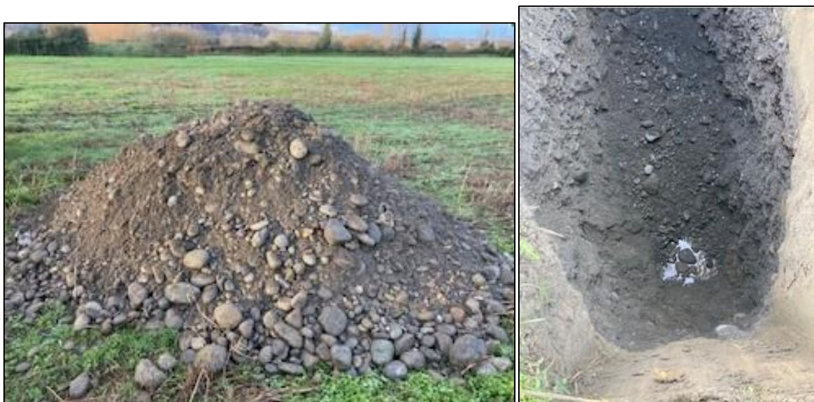
Figure 12 : Photographies de la lithologie observée au droit des sondages (ECR Environnement)
